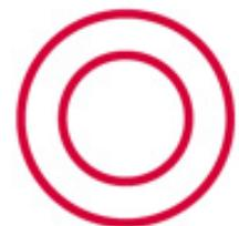
公环尺寸标准需符合：内径 8mm；外径 11 mm；高度 11 mm；且尽量避免使用金属或有镀银成分的公环。
