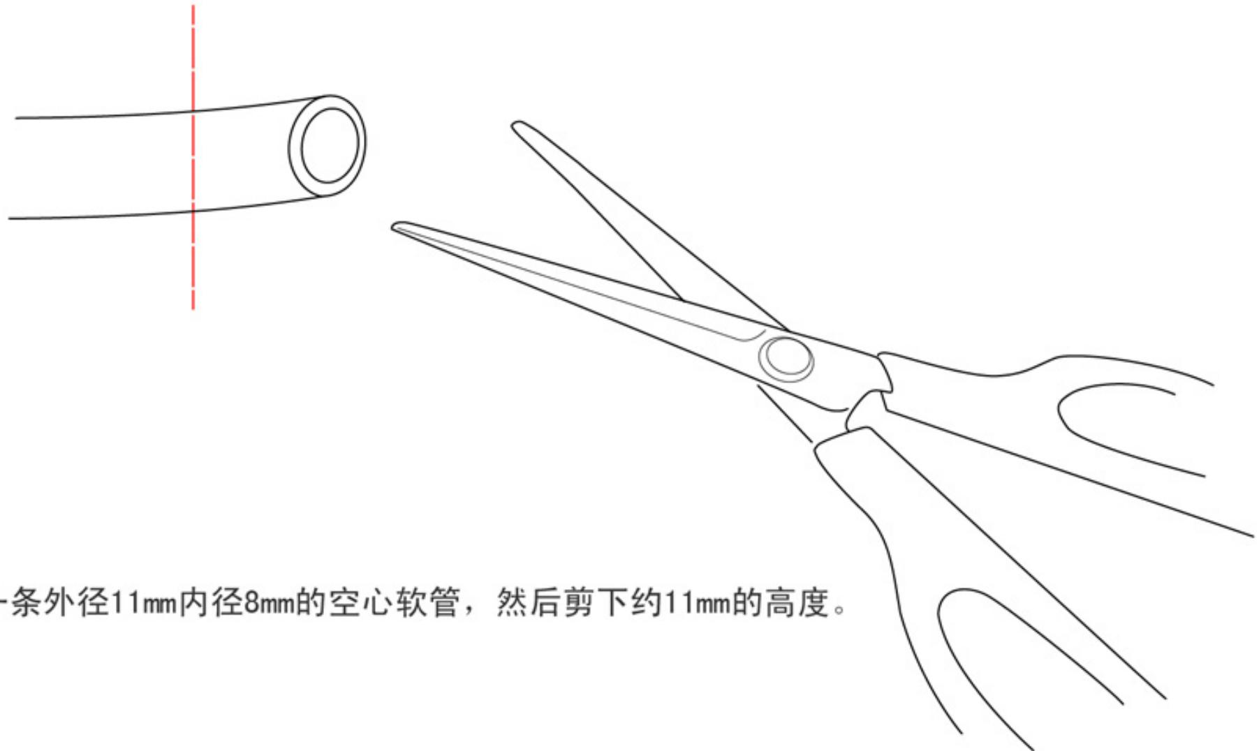
寻找一条外径11mm内径8mm的空心软管，然后剪下约11mm的高度。
